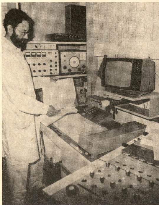
Obr. 4 Ústav fyziologických regulací ČSAV, Praha Experimentátor vně pavlovovské komory (přístroje EEG, EKG, televizní sledování pokusné osoby, zrakové spojení s vnitřkem komory, zdroje podnětů atd.)
