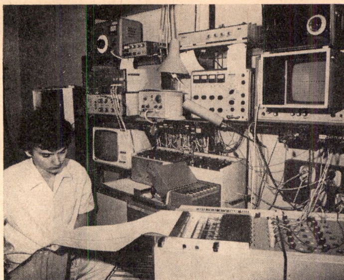
Obr. 5 Ústav fyziologických regulací ČSAV, Praha Experimentátor vně pavlovovské komory (přístroje EEG, EKG, televizní sledování pokusné osoby, zrakové spo- jení s vnitřkem komory, zdroje podnětů atd.)
